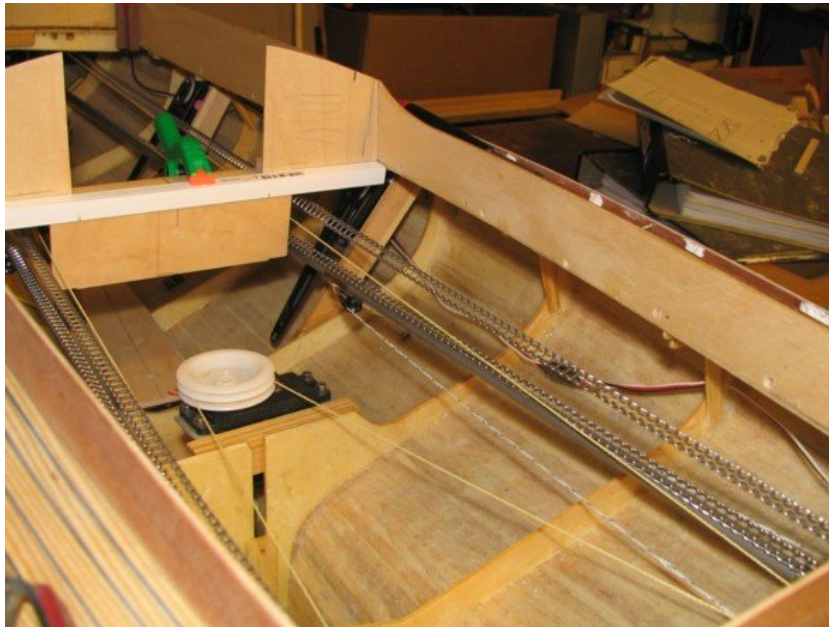
Die Vorsegelwinde. Blick vom Cockpit nach vorne.
